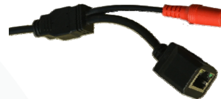
Разъём для подключения к сети Ethernet (RJ-45)
